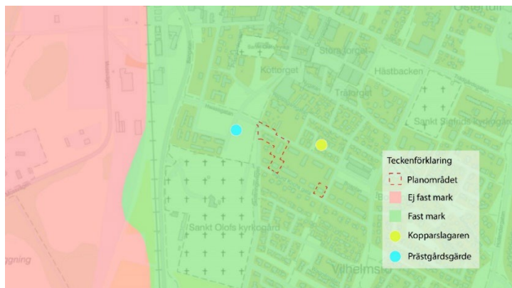
Figur 31 visar planområdets lokalisering inom fast mark samt i förhållande till vart de tidigare geotekniska undersökningarna genomförts.
